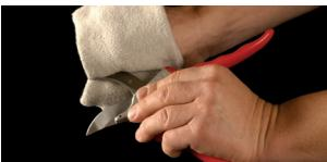
Čišćenjem uklanjate prljavštinu i nakupine biljnog soka te sprječavate zapinjanje stvrdnutih čestica između oštice i nakovanske oštice.
