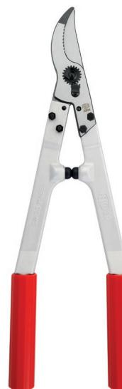
Škare FELCO 20 su kompaktne i snažne pa su pogodne za obavljanje svih vrsta rezidbe. Njihova snaga i snaga rezanja proizlaze iz izdržljivog dizajna od kovanog aluminija i snažne poluge. Rvana rezna glava omogućuje precizno obrezivanje i rezanje jer nazubljena kontra oštrica hvata grane dok oštrica precizno reže grane promjera do 35 mm.
