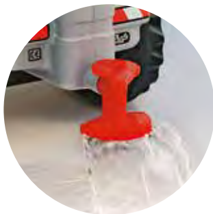
Wasserhahn mit großer Wasserglocke Tap with water spreader device Robinet – grand debit Rubinetto con getto a ventaglio
